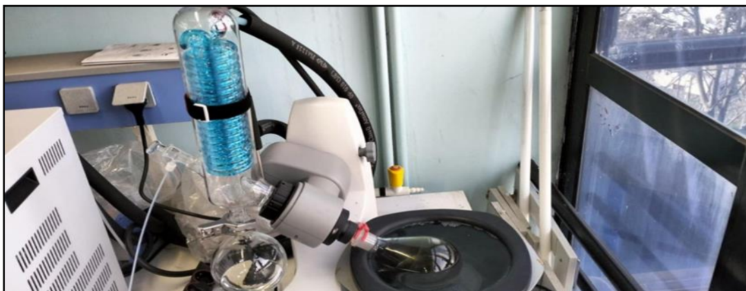
Figure 19 : Évaporation du solvant à l'aide d'un évaporateur rotatif.
